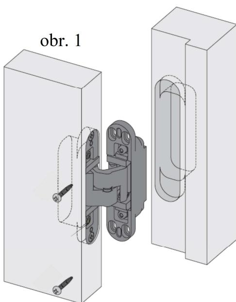
S velikou přesností osadíme zárubeň dle standartního návodu na montáž zárubně. Po vytvrdenutí montážní pěny nejprve předvrtáme otvory pro vruty vrtákem o průměru 3mm poté začneme s montáží skrytých pantů na dveřích pomocí 2ks vrutů 5,0 x 30mm každý pant. Poté přišroubujeme k obložkové zárubní (viz obr. 1) pomocí 2 ks vrutů 5,0 x 30mm.
