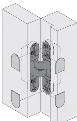
Závěrem na seřizovací šrouby přiložíme krytky, které se zamáčknou do frézovaných drážek.
